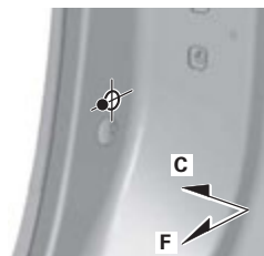
E3 Front Door Switch Mounting Hole \varnothing 8 (0.32)
